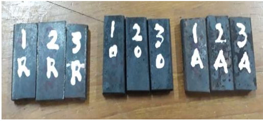
Gambar 4. Spesimen benda uji untuk raw material (R), Oli (O), dan Air (A)
