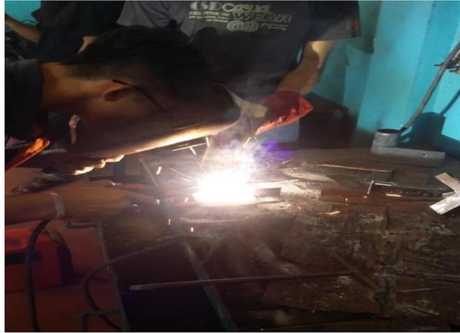
*Gambar 11 Proses pengelasan tanpa media isolator
