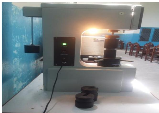
*Gambar 13 Mesin rockwell*
