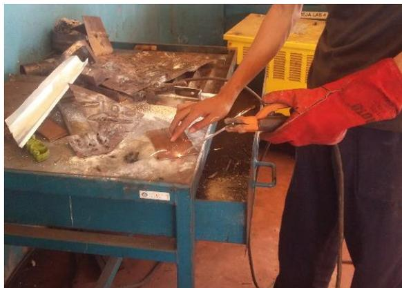
Gambar 6 Las titik pada bagian yang akan disambung
