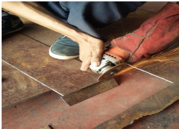
*Gambar 3 Pemotongan bahan uji
