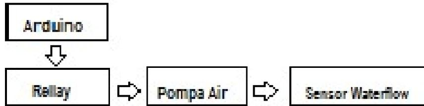
Gambar 3.1 Diagram Blok Perakitan
