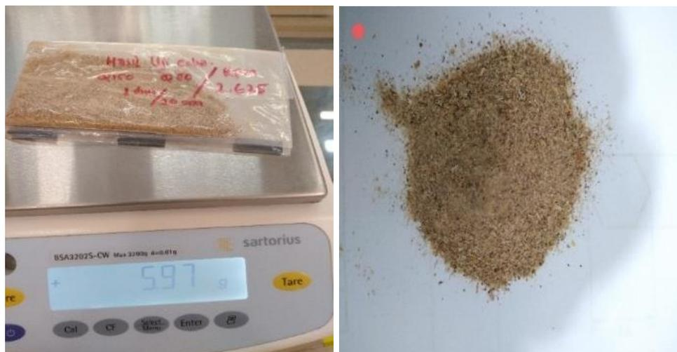
Gambar 4 Hasil Uji Coba Proses Penyerutan Kayu Secang.
