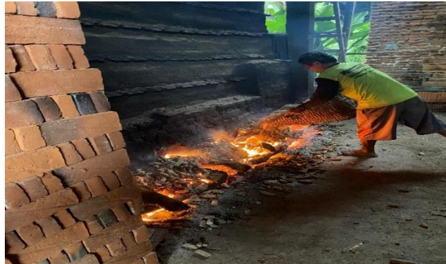
Gambar 2 Penuangan Bahan Bakar Selama Proses Pembakaran Batu Bata
