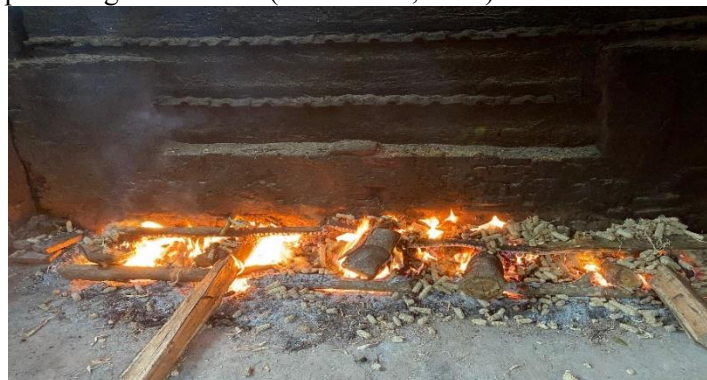
Gambar 3 Proses Pembakaran Batu Bata
