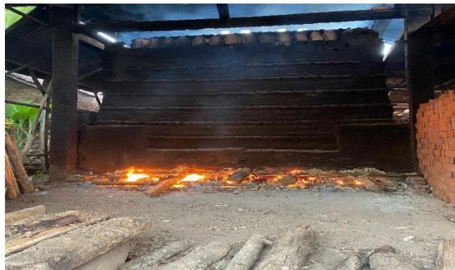
Gambar 1 Proses Pembakaran Batu Bata
