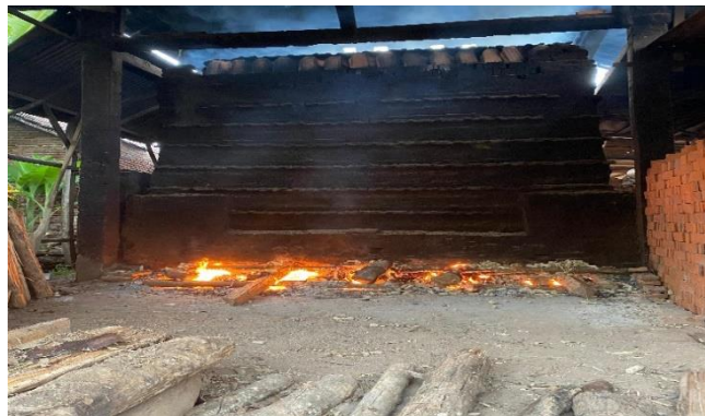
Gambar 1 Proses Pembakaran Batu Bata
