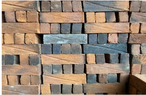
Gambar 7 Batu Bata Selama Pembakaran Berada Di Posisi Bawah
