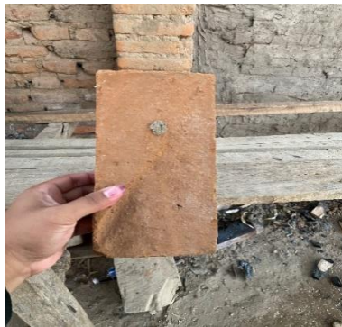
Gambar 5 Batu Bata Belum Sempurna
